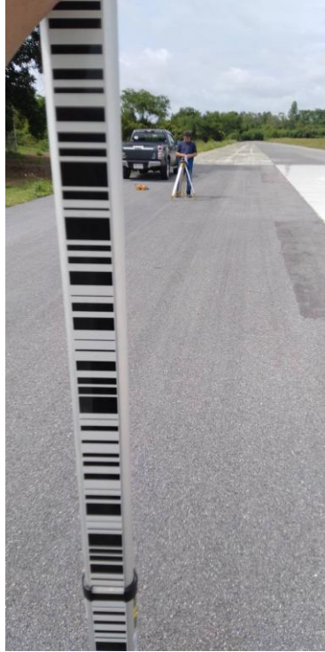
ภาพที่ 3.32 การวัดระดับความลาดชันบริเวณสนามทดสอบ
