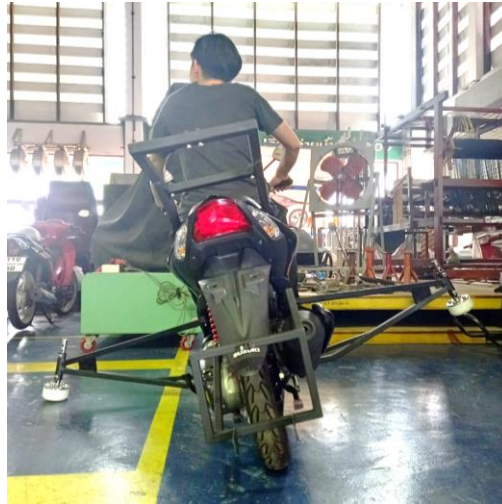
ภาพที่ 3.17 รถจักรยานยนต์หลังติดตั้งอุปกรณ์ป้องกันการพลิกคว่ำ
