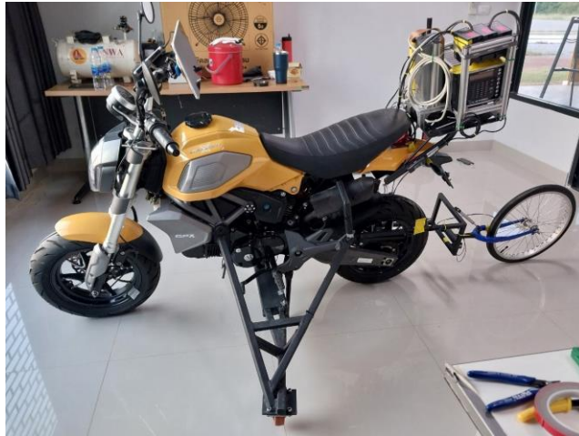
ภาพที่ 3.15 การติดตั้งอุปกรณ์เก็บข้อมูลบริเวณแร็คบรรทุกของด้านท้ายแบบเปิดโล่ง
