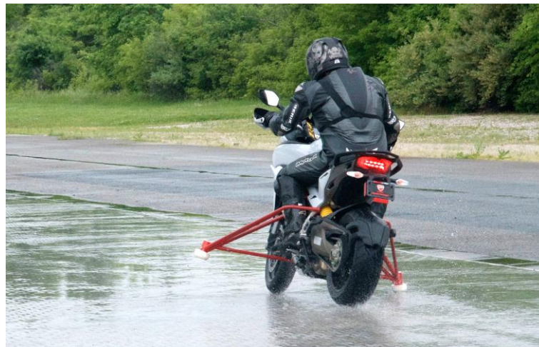
ภาพที่ 2.20 รถจักรยานยนต์ที่ติดตั้งขาตั้งขณะทดสอบบนพื้นเปียกน้ำ [21]
