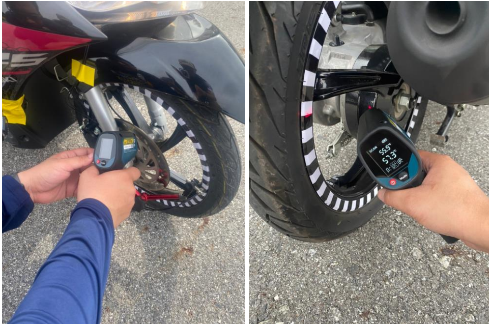
ภาพที่ 3.35 การวัดอุณหภูมิที่ห้ามล้อหน้าและหลังก่อนทำการทดสอบ
