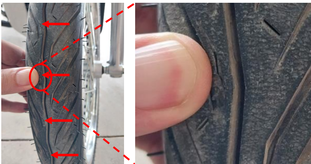
ภาพที่ 4.64 รอยฉีกขาดตามแนวเส้นรอบวงของยางล้อ
