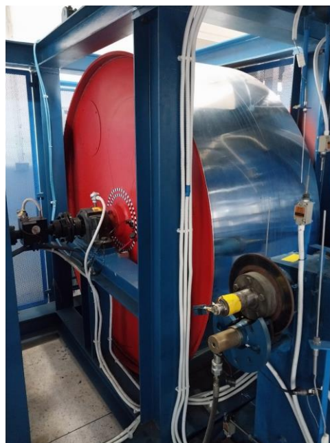
ภาพที่ 3.21 ล้อทรงกระบอกของเครื่องวัดความต้านทานการกลิ้งล้อและการติดตั้งแถบสติ๊กเกอร์วัดความเร็ว
