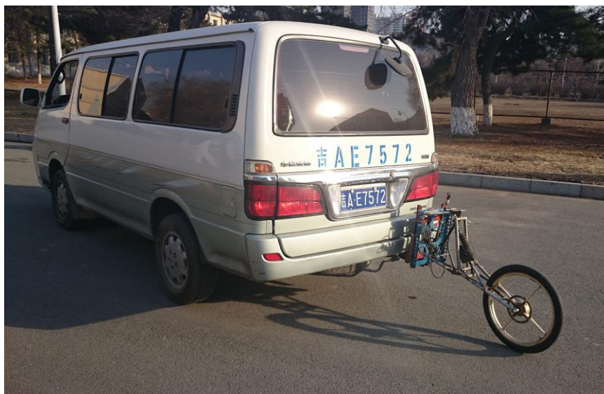
ภาพที่ 2.13 การวัดความเร็วยานพาหนะด้วยล้อที่ห้า [14]
