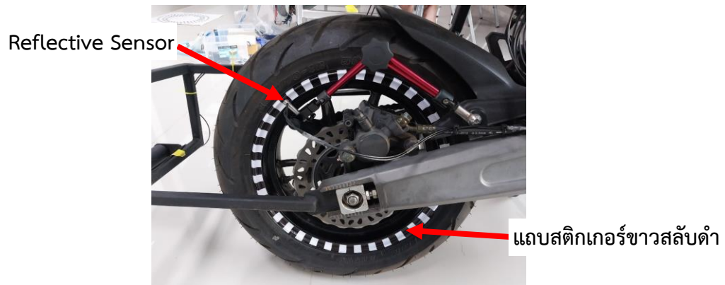
ภาพที่ 3.9 การติดตั้งแถบสติ๊กเกอร์ที่ล้อและการใช้ตัวรับรู้วัดการสะท้อนของแถบสติ๊กเกอร์
