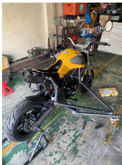
ภาพที่ 3.26 การติดตั้งอุปกรณ์กันพลิกคว่ำ
