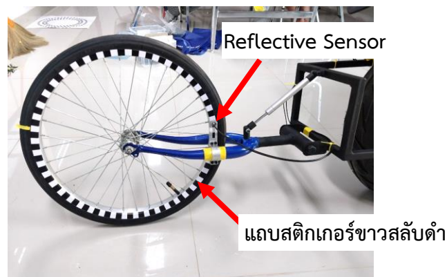
ภาพที่ 3.10 ล้อที่สามและการติดตั้งแถบสติ๊กเกอร์พร้อมตัวรับรู้เพื่อวัดความเร็ว
