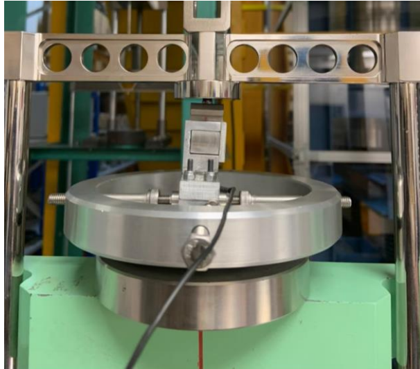
ภาพที่ 3.5 การเสียรูปของเครื่องมือวัดแรงห้ามล้อที่มีมือระหว่างการสอบเทียบ
