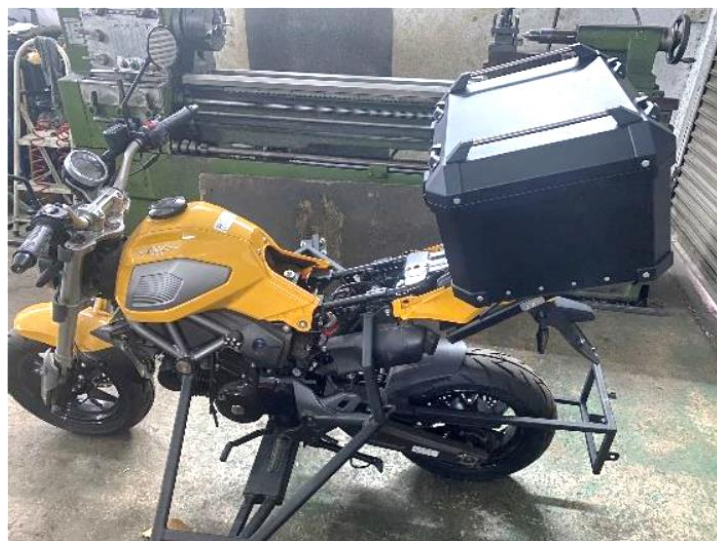
ภาพที่ 3.14 การติดตั้งกล่องระบบเก็บข้อมูลบริเวณแร็คบรรทุกของด้านหลัง
