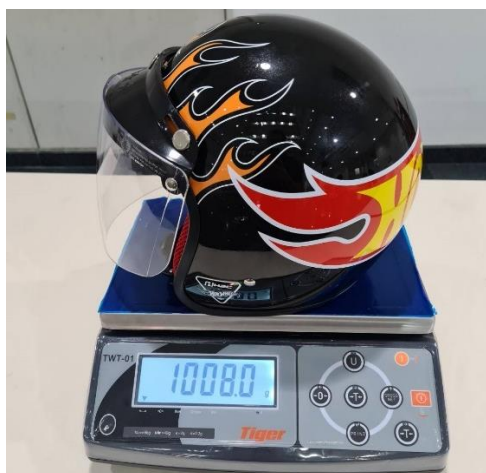
รูป 3-4 การชั่งน้ำหนักตัวอย่างหมวกนิรภัย
